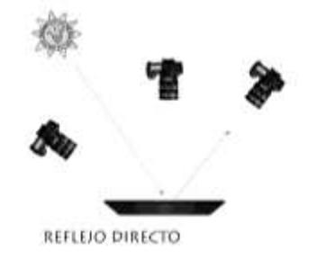
Una de las tres cámaras percibe un reflejo, mientras que las otras dos cámaras no. Los haces de luz rebotan siguiendo un ángulo idéntico al de la incidencia, concretamente:
